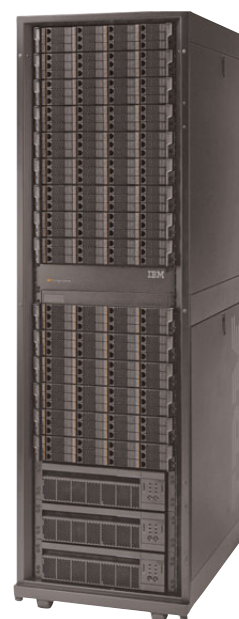
IBM XIV: Одноуровневая система хранения данных на основе масштабируемой grid-архитектуры
