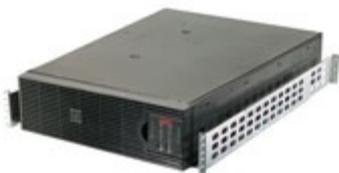
APC Smart-UPS RT 3000 RM, 2100 Watts / 3000 VA, Входной 230V / Выход 230V, Interface Port Smart-Slot, Extended runtime model, Высота аппаратной стойки 3 U
